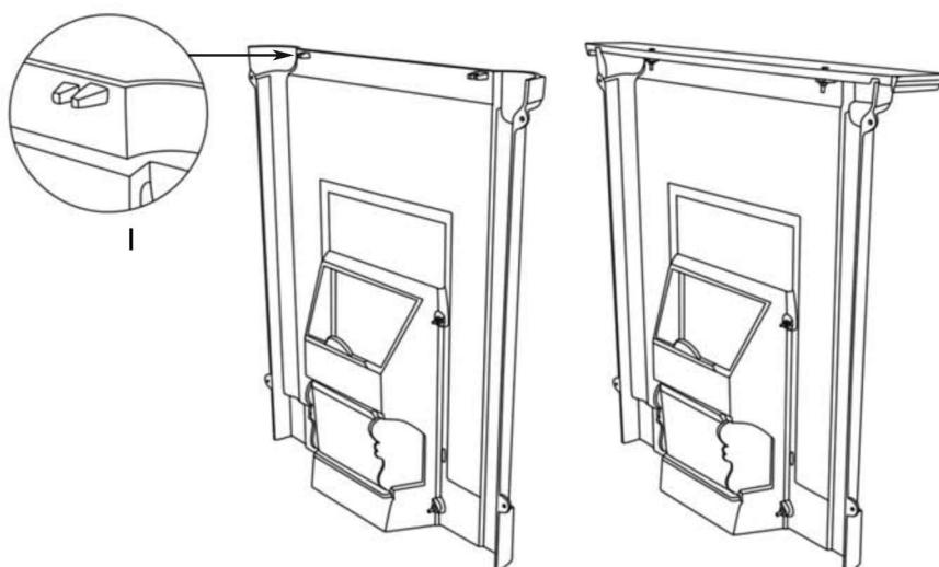
Положите каминную полку на камин и вставьте два болта M8 в отверстия на полке таким образом, чтобы они проходили через крепежные выступы (рис.1) на обратной стороне камина. Для закрепления каминной полки следует использовать две шайбы M8 и 2 гайки M8, затянутые плоской отверткой.
