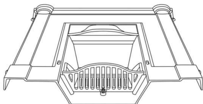
Вставьте колосник в пазы над гайкой M6. Закрепите на месте при помощи шайбы и болта M6.
